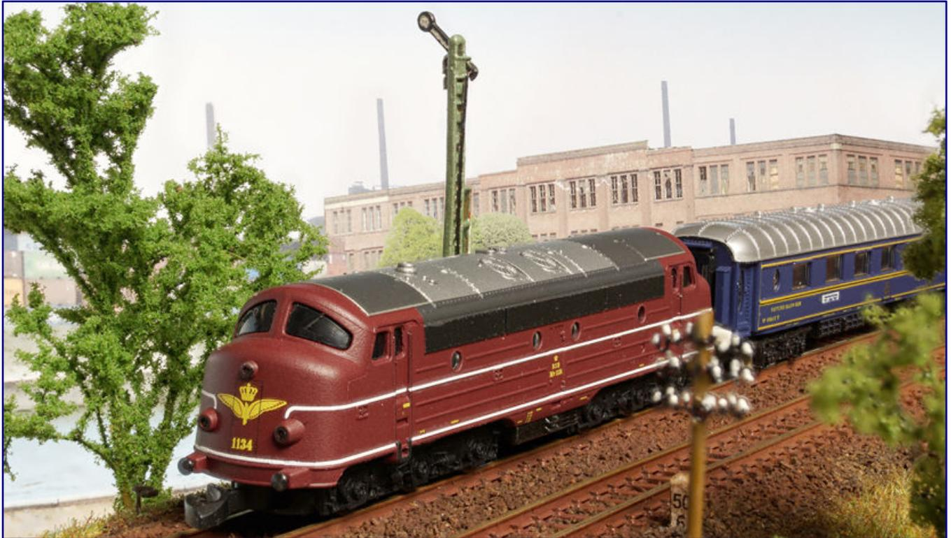
Im Mai stellte sich erstmals ein Lokmodell mit einem Gehäuse aus metallgefülltem Kunststoff unserem Test. Der Gewichtszuwachs sorgte für deutlich besseres Traktionsverhalten, an dem auch der nun verbaute Glockenankermotor mitwirkt.
